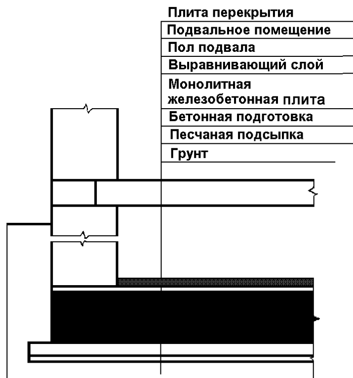
Рис. 5. Радонозащитный барьер в виде фундаментной плиты
